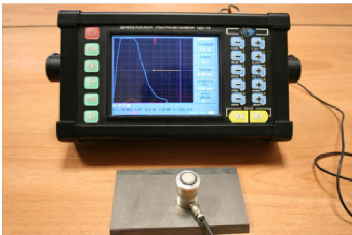
Рисунок 3.2 – Ультразвуковой дефектоскоп УД2-70
