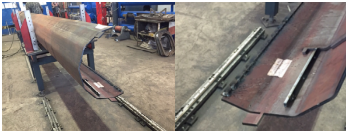
Рисунок 2.3 – Приварка подложки к нижней части короба
