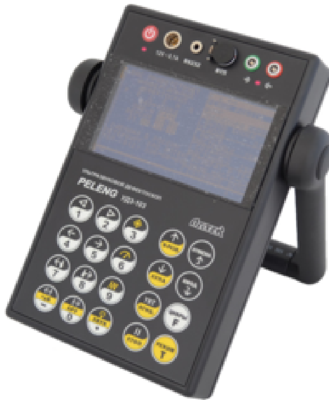
Рисунок 3.2 - Универсальный ультразвуковой дефектоскоп УДЗ-103 Пеленг
