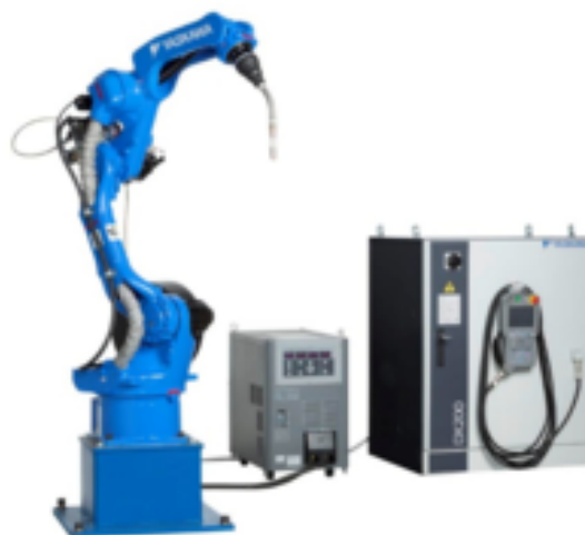
Рисунок 2.12 – Робот YaskawaMotomanMA1440, совместно с контролером Yaskava YRC1000
