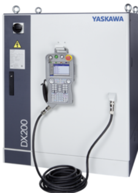
Рисунок 2.15 – Контроллер Yaskawa DX-2000
