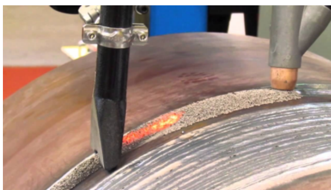
Рисунок 2.14 – Пример Сварки под флюсом
