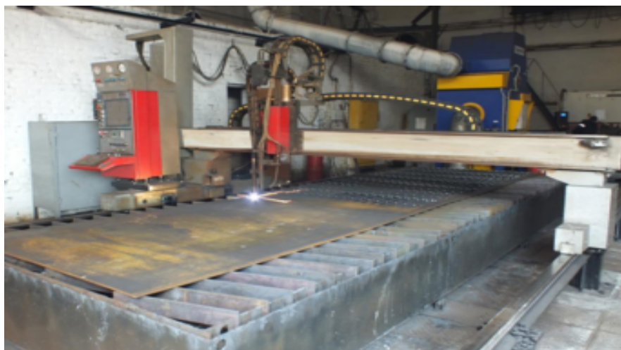
Рисунок 2.2 – Резка листов с помощью термическим способом
