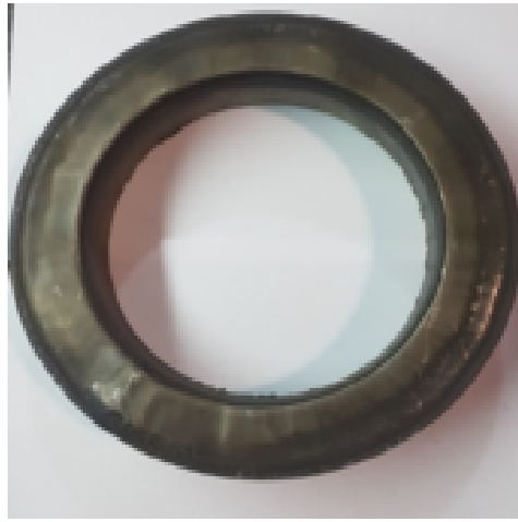
Рисунок 3.3 – Образец №2, наплавленный порошком ПР-НХ17СР4 по стали 12Х18Н10Т
