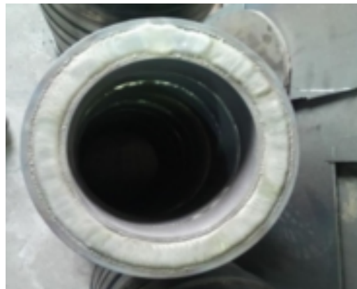
Рисунок 3.4 – Образец №3, наплавленный порошком ПР-НХ17СР4+30%WC по стали 20Х13
