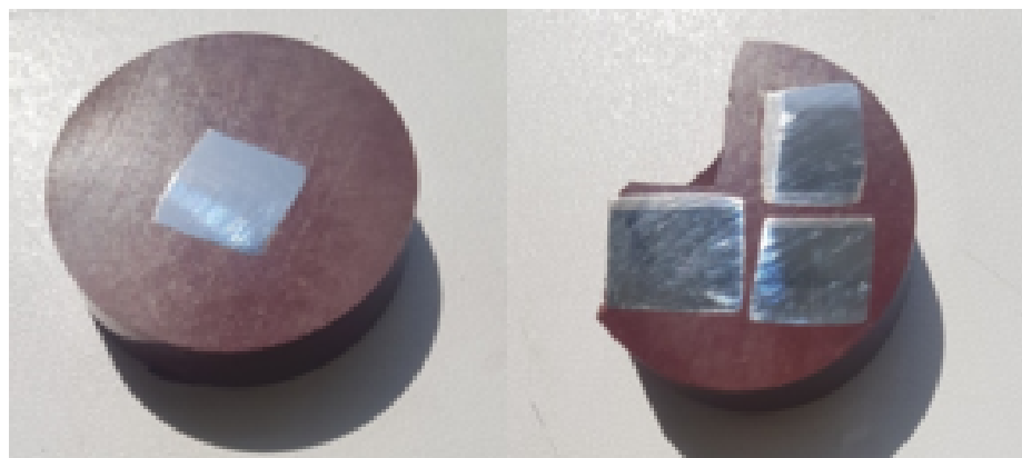
Рисунок 3.13 – Шлифы после полирования
