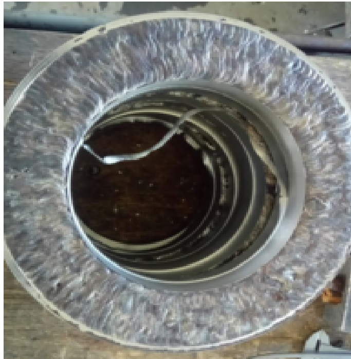
Рисунок 2.5 – Кольцо разгрузки после наплавки
