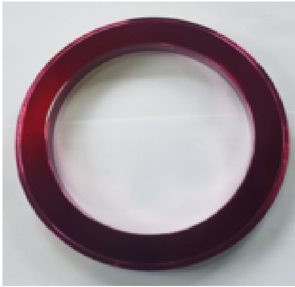
Рисунок 3.7 – Кольца разгрузки после проведения капиллярного контроля: а – Нанесение пенетранта ; б – Нанесение проявителя
