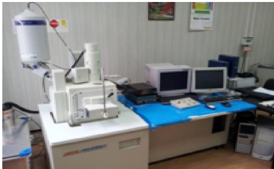
Рисунок 3.25 – Растровый электронный микроскоп JEOL JSM-6460LV.
