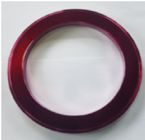
Рисунок 3.8 – Кольцо разгрузки после проведения капиллярного контроля: а – Нанесение пенетранта ; б – Нанесение проявителя
