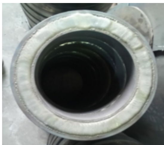
Рисунок 3.2 – Образец №1, наплавленный порошком ПР-НХ17СР4+30%WC по стали 12Х18Н10Т
