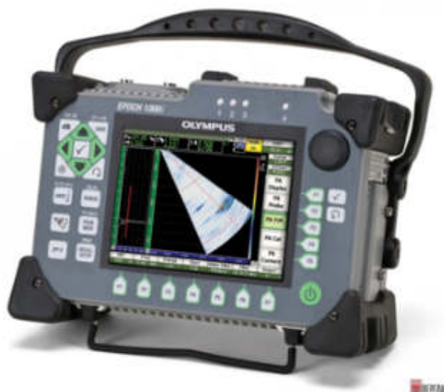
Рисунок 2.8 – Ультразвуковой дефектоскоп EPOCH 1000i
