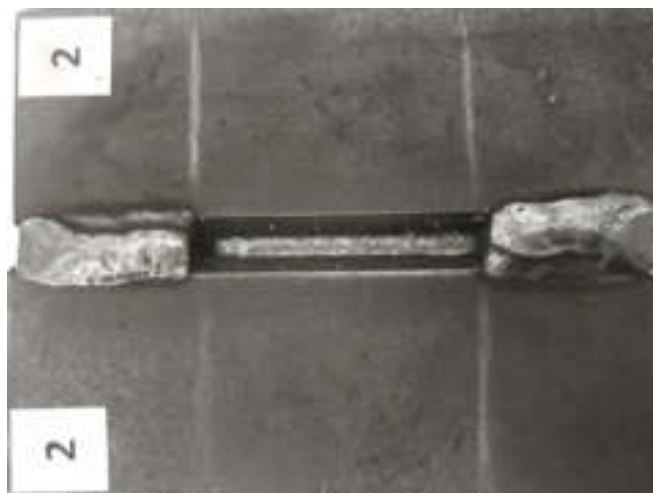
Рисунок 3.31 – Фотография готовой к испытаниям пробы «Тэккен»
