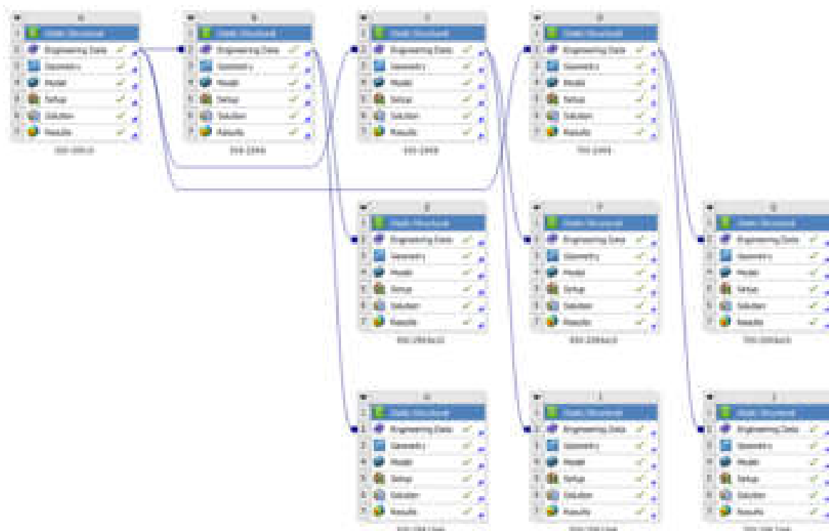
Рисунок 3.4 – План эксперимента в Ansys Workbench
