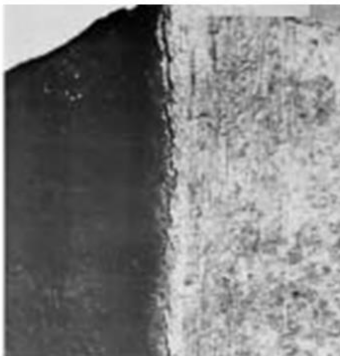
Рисунок 18 – продольные поверхностные трещины
