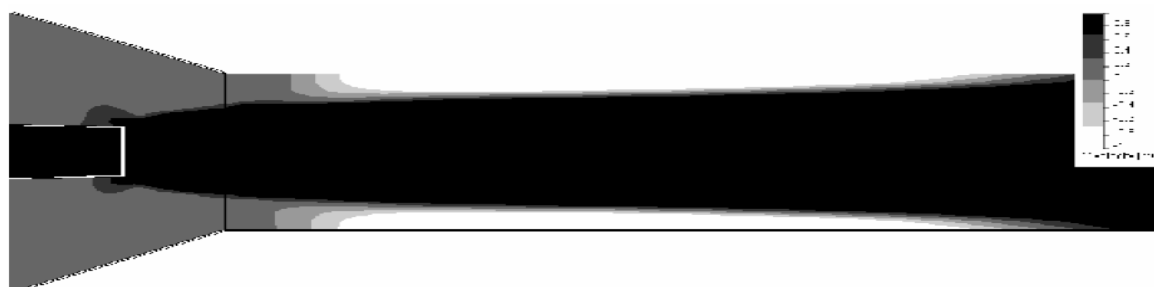
Рисунок 10 – Изолинии осевой составляющей скорости в камере смешения эжектора с m=11 , q=0,25
