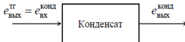
Рисунок 15 – Схема расчета эксергетического баланса
