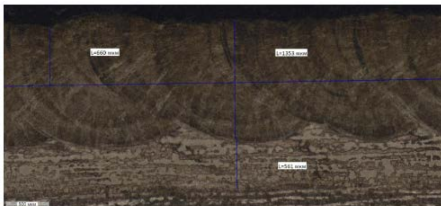
Рисунок 6.3.3 Шлиф образца с наплавленной проволокой 2.2 в поперечном сечении: А – начало, Б – центр, В – конец
