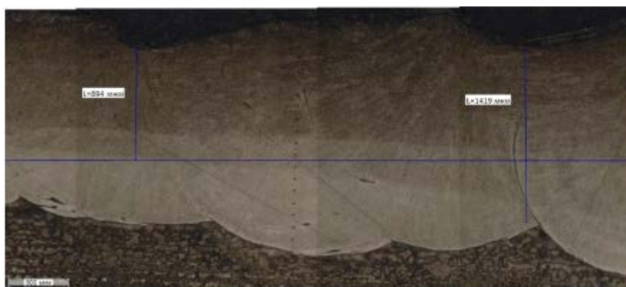
Рисунок 6.3.1 Шлиф образца 2.1 с наплавленной проволокой в поперечном сечении: А – начало, Б – центр, В – конец
