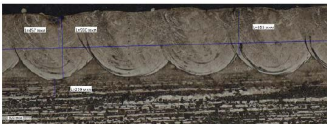
Рисунок 6.2.2 Шлиф образца 1.1 с наплавленным порошком в поперечном сечении: А – начало, Б – середина, В – конец
