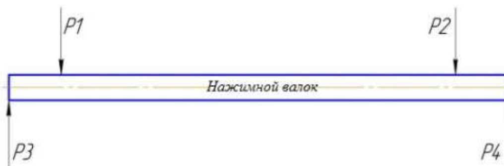
Рисунок 8 – Схема нагружения нажимного валка усилиями противоизгиба:
