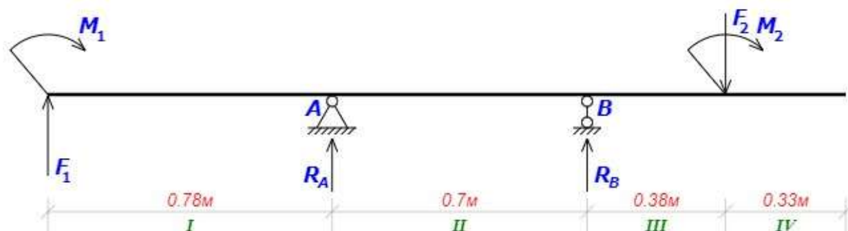
Рисунок 5.5 – Расчетная схема действующих на вал сил
