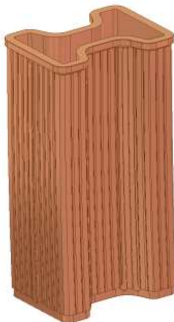
Рисунок 18 – Трубчатая гильза кристаллизатора
