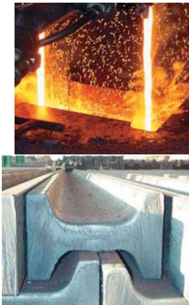
Рисунок 6 – Разливка стали на фасонную заготовку двумя струями (сверху) и внешний вид такой заготовки (снизу)
