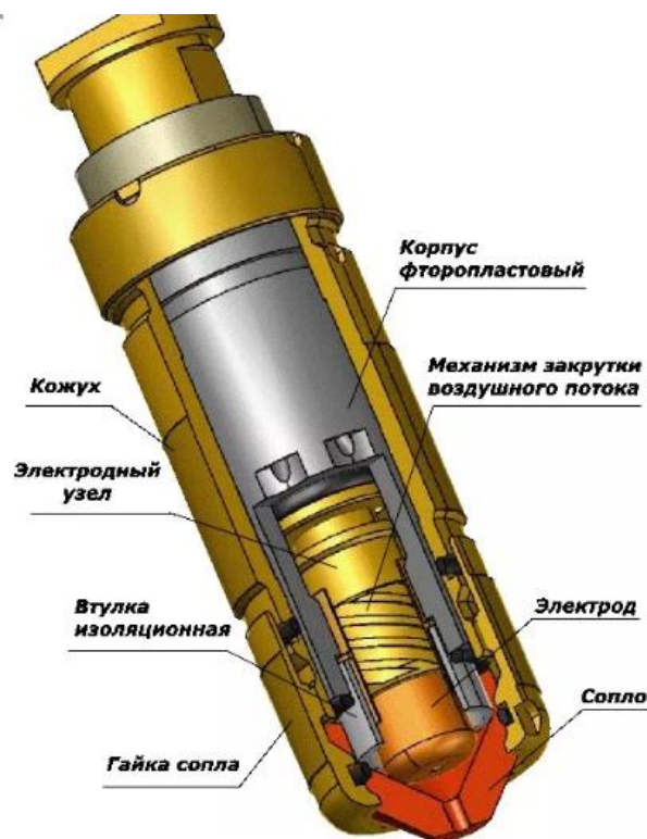
Рис. 4.1 – Устройство плазмотрона
