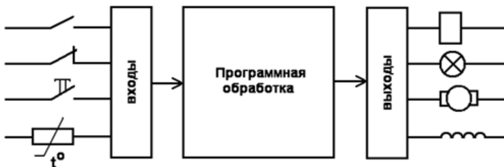
Рисунок 14 – Рабочий цикл ПЛК
