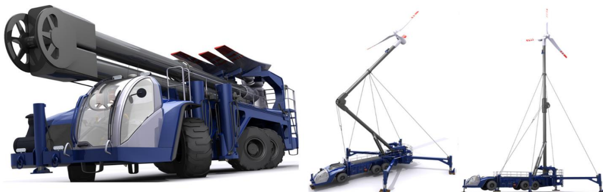
Рисунок 4.3 – Мобильная ветроэнергетическая установка
