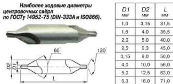
Рисунок 3.11 - Центровочное сверло DIN-333A
