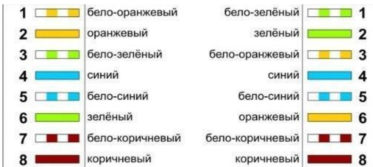
Рисунок 3.4 Схема перекрестного обжима витой пары (камера-маршрутизатор)
