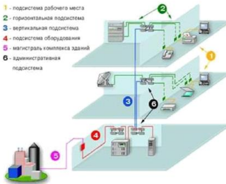
Рисунок 2 Структура корпоративной сети Цеха №116
