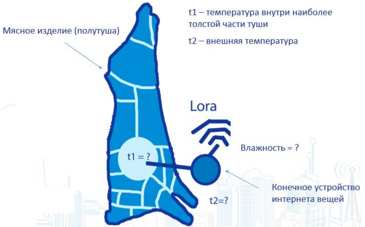
Рисунок 7 – Конечное устройство на мясной туше
