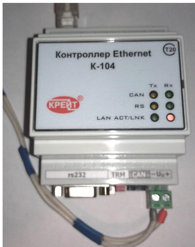
Рисунок 3.21 - Подключение К-104 Ethernet
