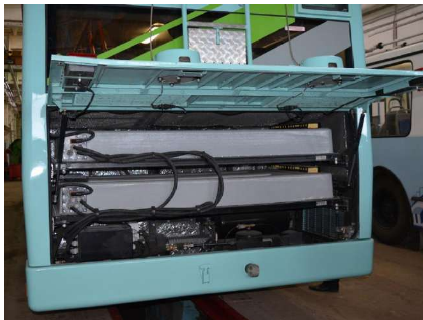
Рисунок 1.15 – Расположение аккумуляторных батарей в троллейбусе БКМ-32100D
