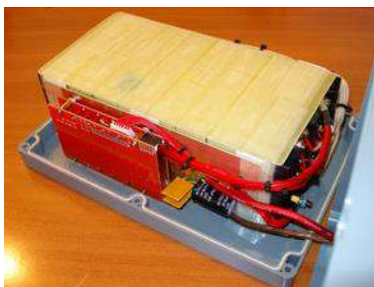
Рисунок 1.8 - Литий-титанатная аккумуляторная батарея
