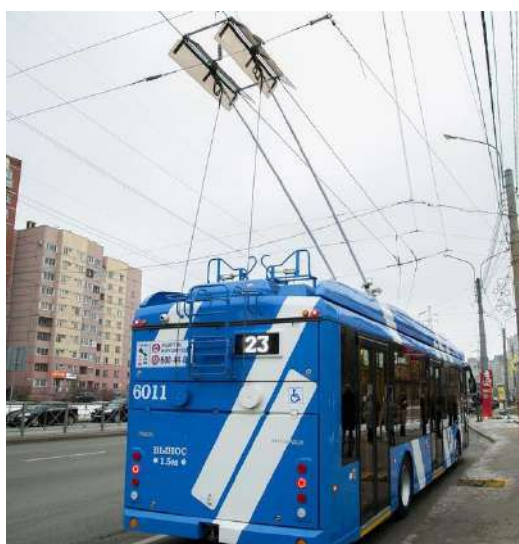
Рисунок 1.10 - Автоматическое подключение токоприёмников к контактной сети при помощи «ловушки»
