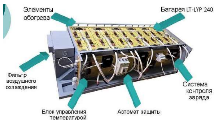
Рисунок 2.11 - Составные элементы батарейного блока КАТ 240НЛ
