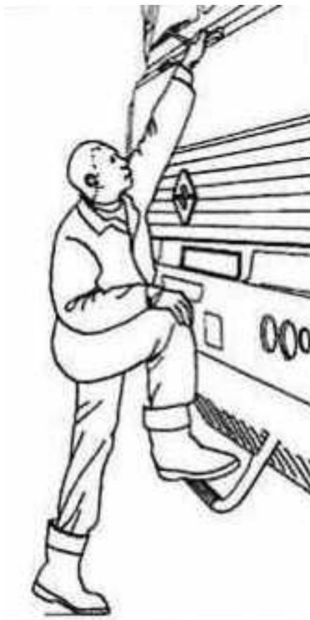
Рисунок 5.1 - Прием использования подножки и вспомогательной ручки для подъема на буфер и спуска с него
