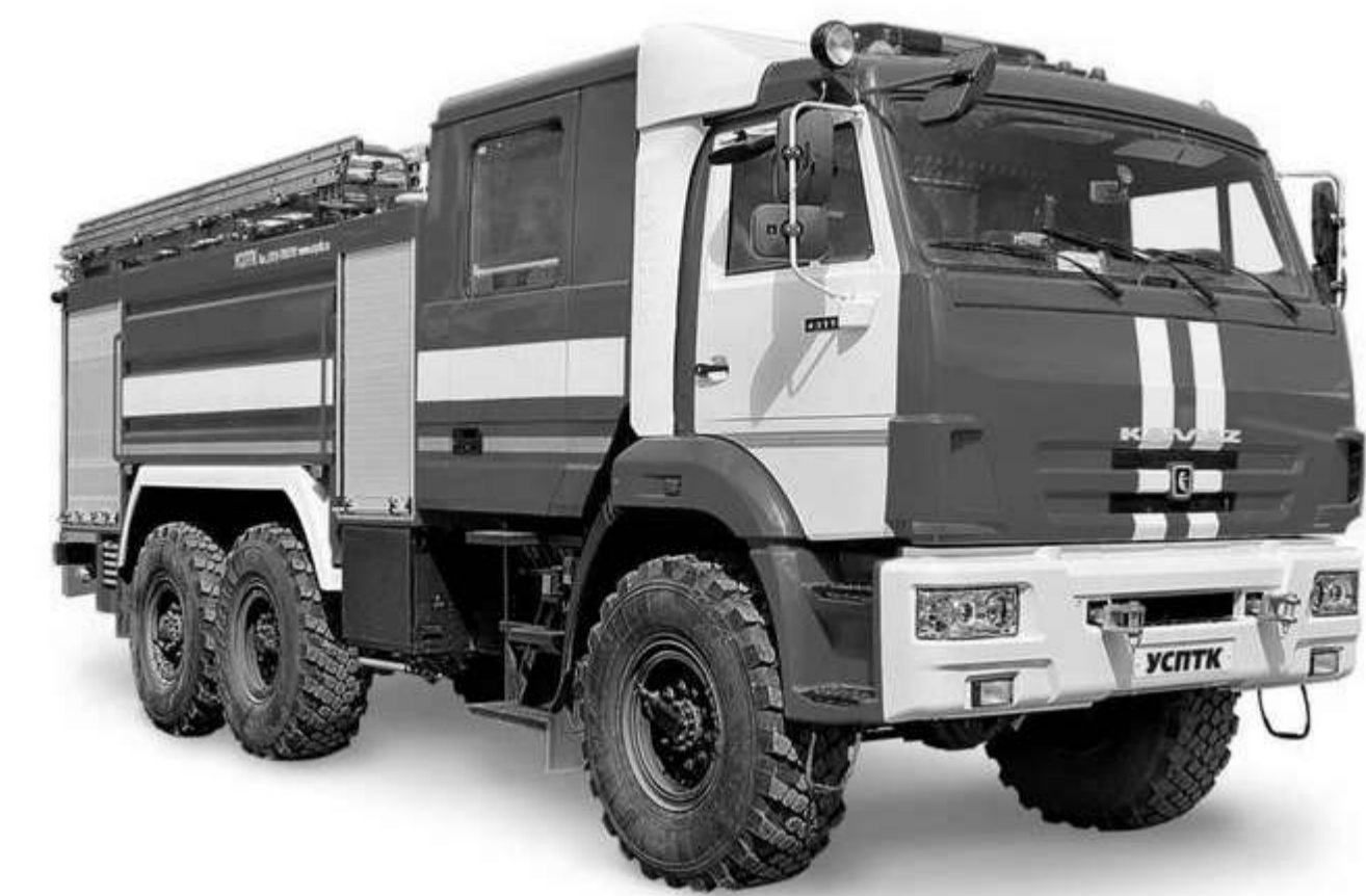
КАМАЗ 43118 АЦ-8.0 Насос центробежный пожарный нормального давления НЦПН-40-100
