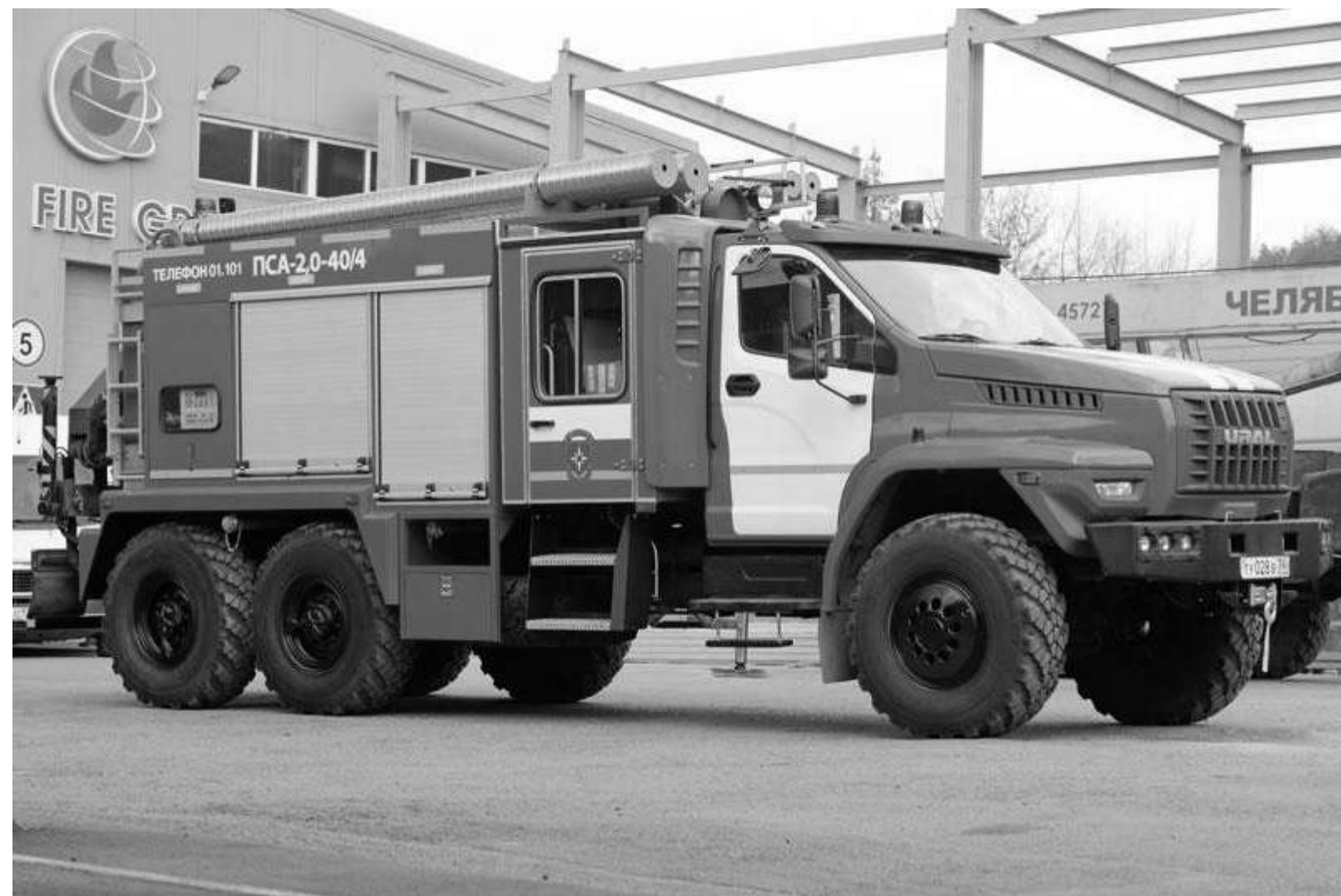
Урал 5557 ПСА-2,0 Насосный агрегат НЦПВ-40/4-РТ
