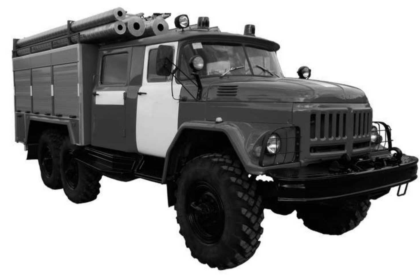
Зил 131, АЦ 40 Насос центробежный пожарный ПН-40УВ.01
