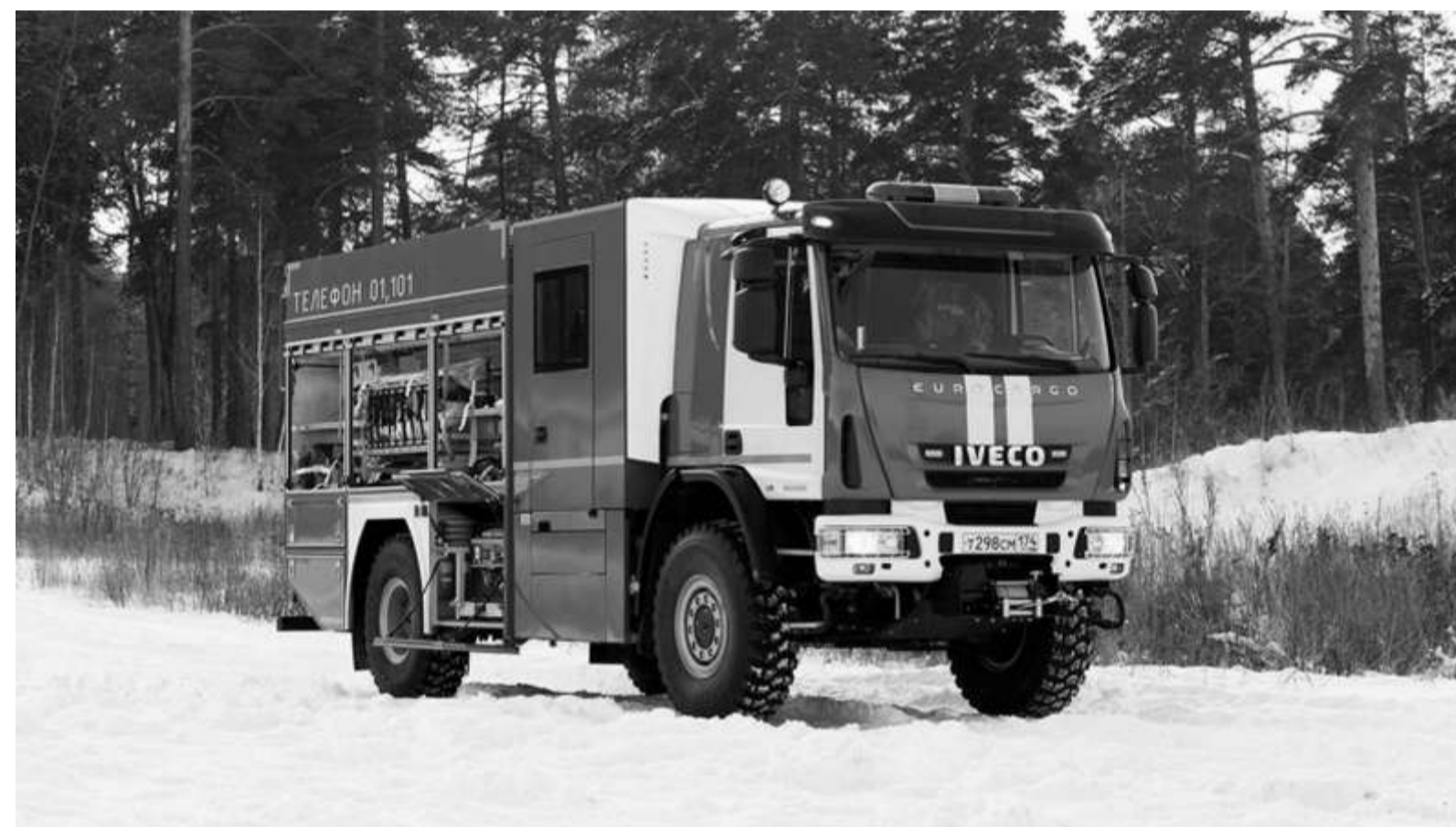
АЦ 3,2-40/2 (IVECO ML150) Насос пожарный нормального давления НЦПН-100/100
