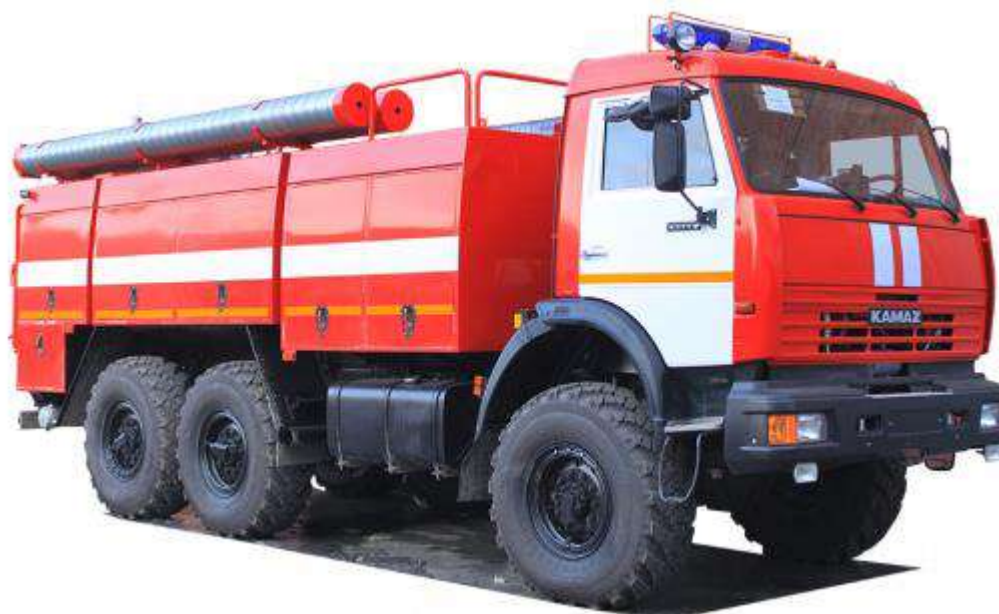
Рисунок 1.2 - Общий вид пожарной насосной станции на базе автомобиля Камаз 5350
