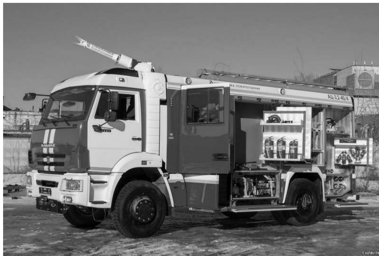
КамАЗ 5387 Пожарный насос Rosenbauer NH-30 АЦ 3,2-40-4
