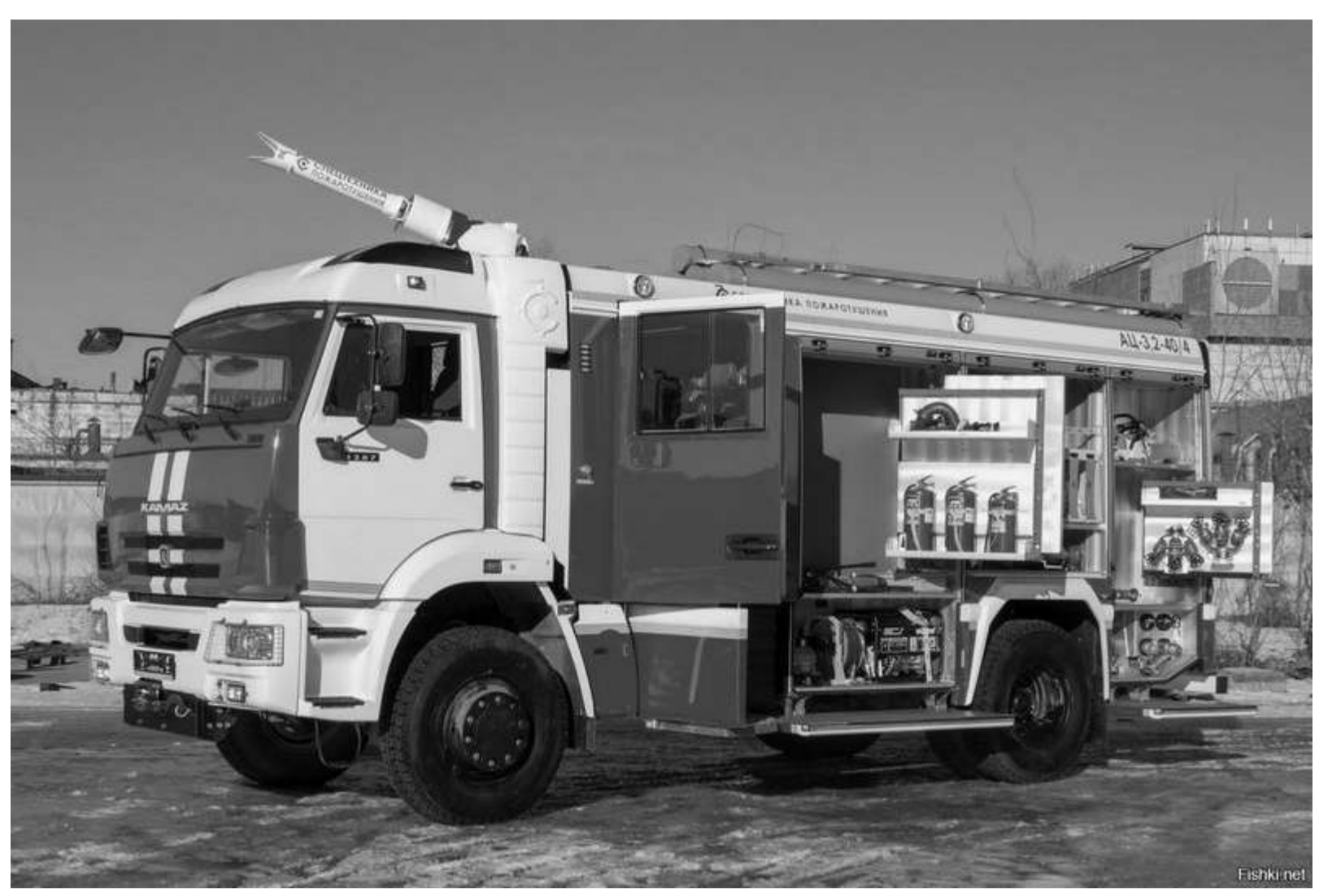
КамАЗ 5387 Пожарный насос Rosenbauer NH-30 АЦ 3,2-40-4
