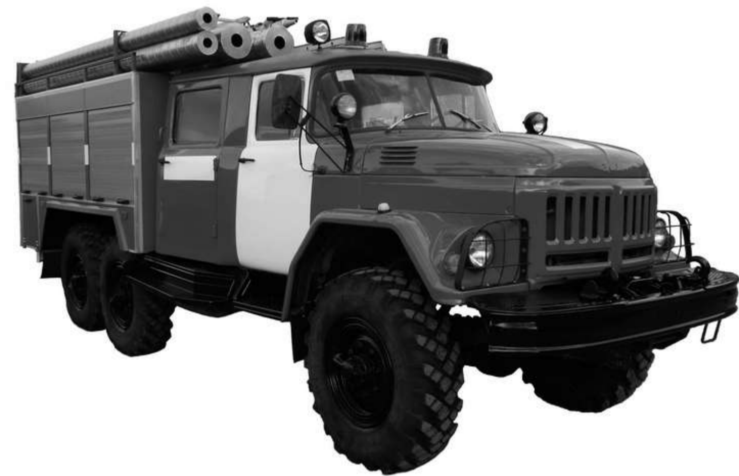
Зил 131, АЦ 40 Насос центробежный пожарный ПН-40УВ.01
