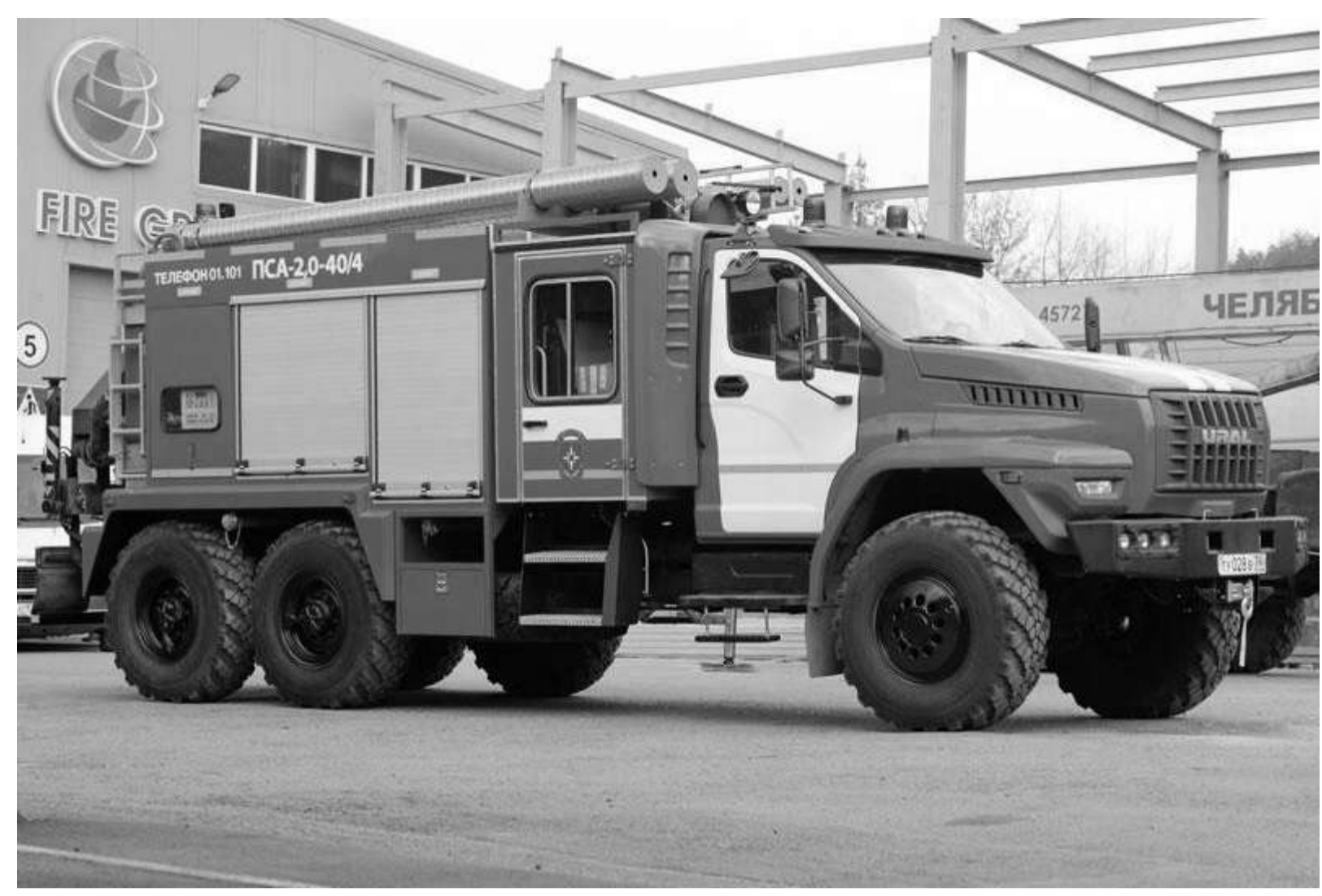
Урал 5557 ПСА-2,0 Насосный агрегат НЦПВ-40/4-РТ
