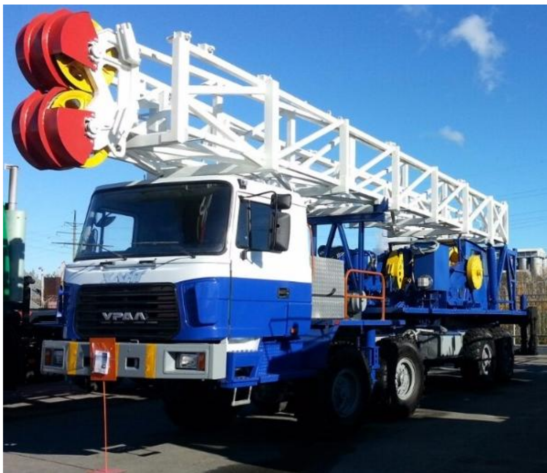
Рисунок 1.4 – Автомобиль ХАНТ на базе шасси Урал 5323, с установленной кабиной Урал
