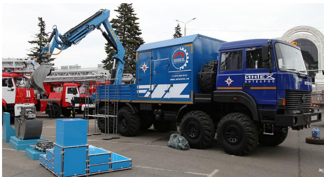
Рисунок 1.2 - Агрегат для перевозки нефтегазопромыслового оборудования оснащенный краном-манипулятором производства ЗАО «Инман» (г. Ишимбай)
