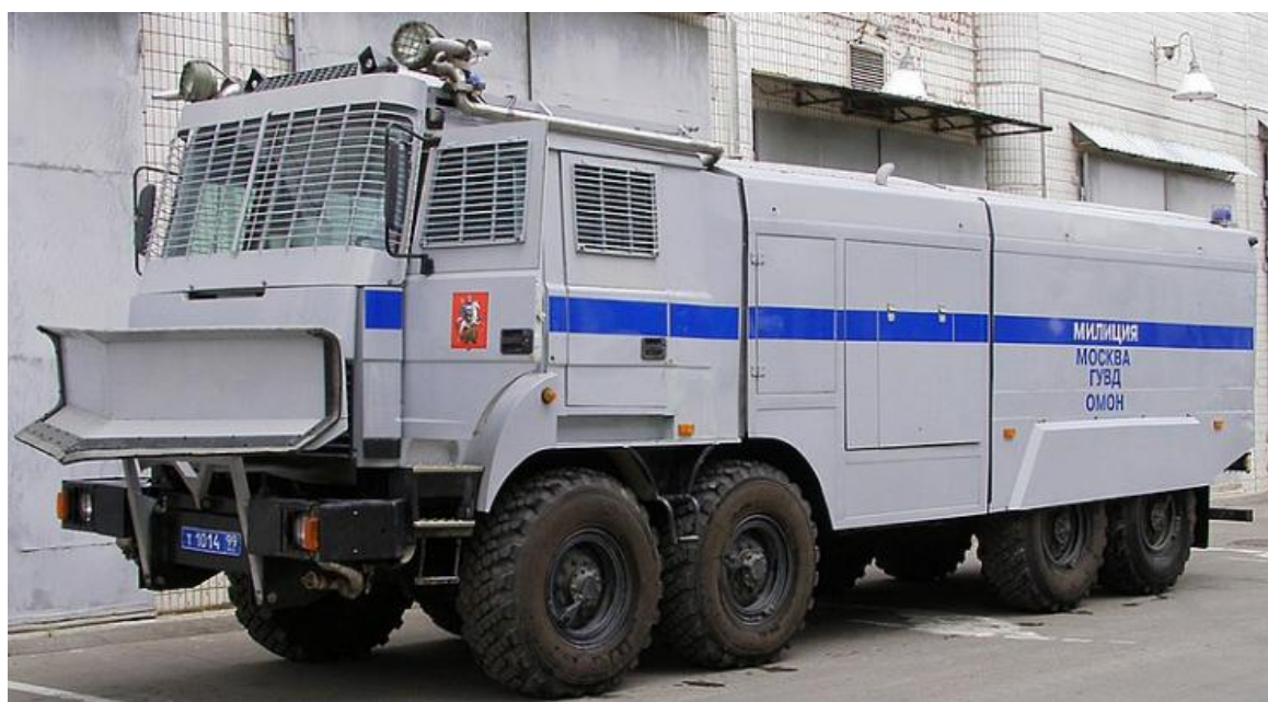
Рисунок 1.3 - Водометный спецавтомобиль «Лавина-Ураган» на шасси Урал-5323
