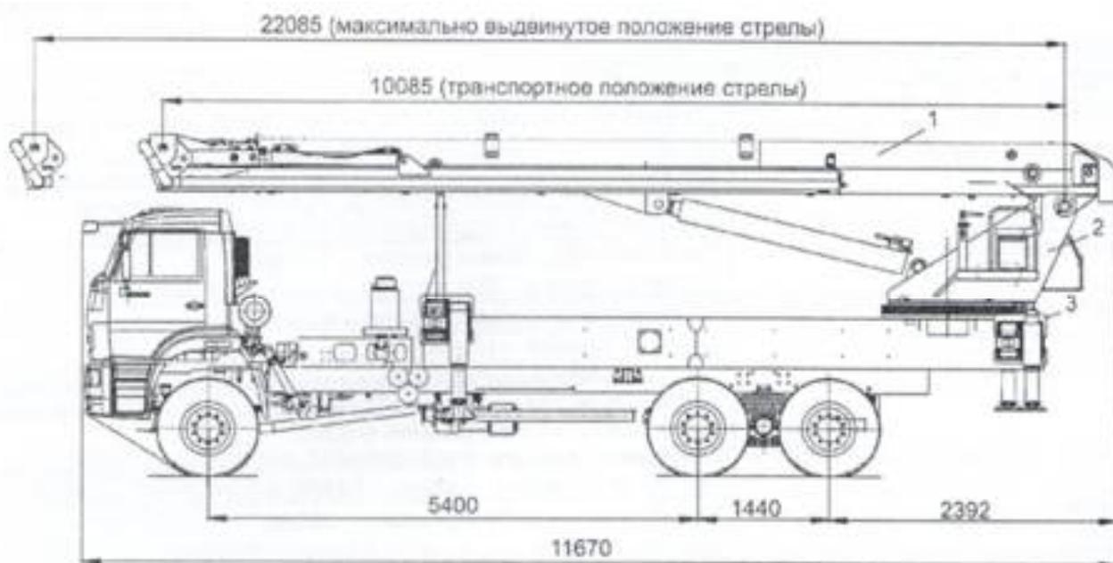
Рисунок 1 – Габаритный чертеж автопеноподъемника
