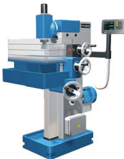
Рисунок 5.- Станок фрезерный широкоуниверсальный ФСМ-250/676.
