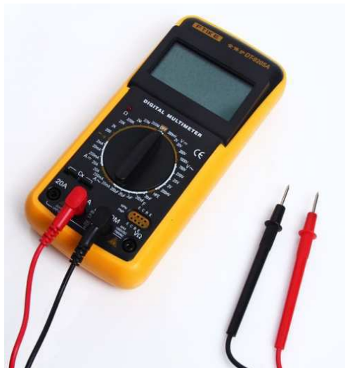
Рисунок 2 - Мультиметр цифровой -цеховое приспособление 25/5786-1(рисунок 3).
