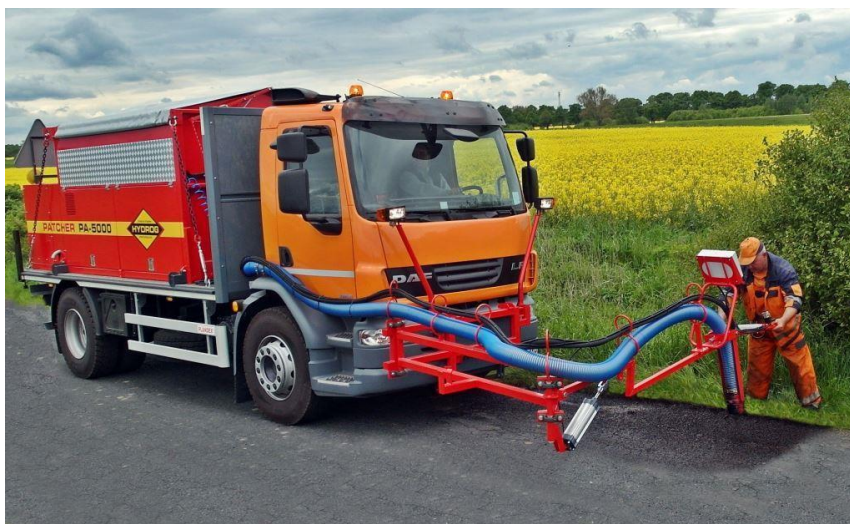
Рисунок 3.1 - Машина для ямочного ремонта HYDROG PA 5000
