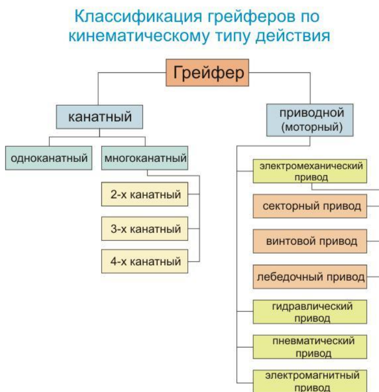
Рисунок 3.6 - Классификация грейферов
