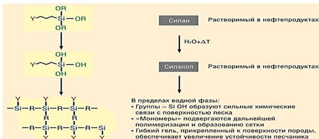
Рисунок 3.1 – Принцип действия технологии SECURE
