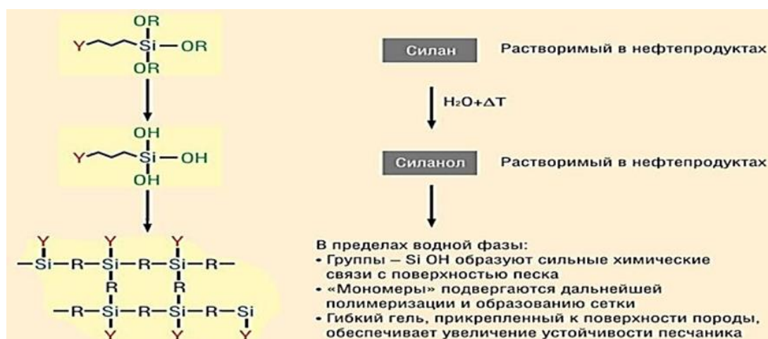
Рисунок 3.1 – Принцип действия технологии SECURE
