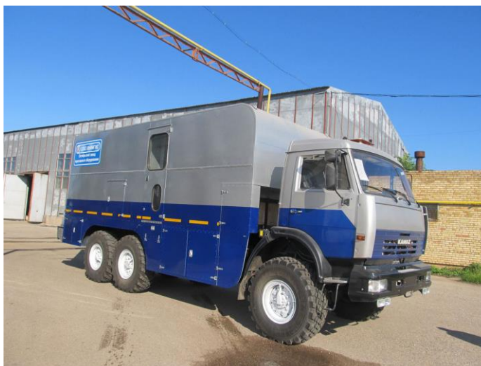
Рисунок 3.1 – Комплекс для геофизического исследования скважин КАРСАР
