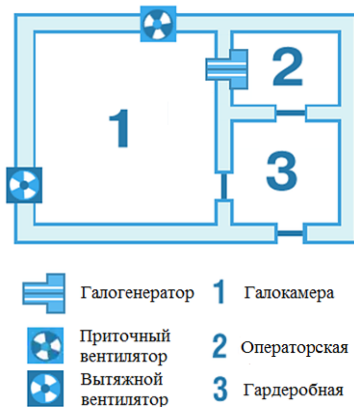
Рисунок 3.1 – Предварительный план помещений и размещения оборудования
