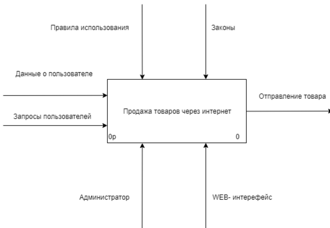
Рисунок 3.1 – Контекстная диаграмма функциональной модели
