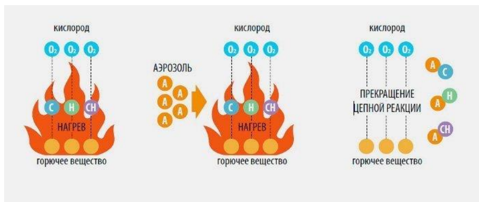
Рисунок 1.9 – Принцип действия аэрозольных систем пожаротушения
