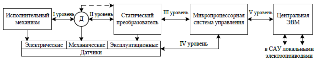
Рисунок 1.1 – Структура многоуровневой системы интерфейсов электропривода
