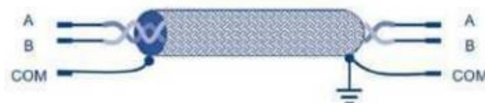
Рисунок 2.3 – Помехозащищенная витая пара
