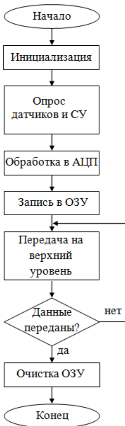
Рисунок 2.12 – Алгоритм работы контроллера телемеханики
