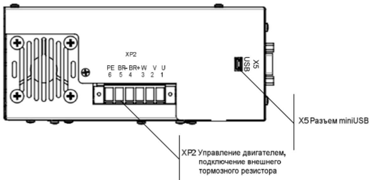
Рисунок 4.4- Силовые разъемы сервоусилителя СПС25
