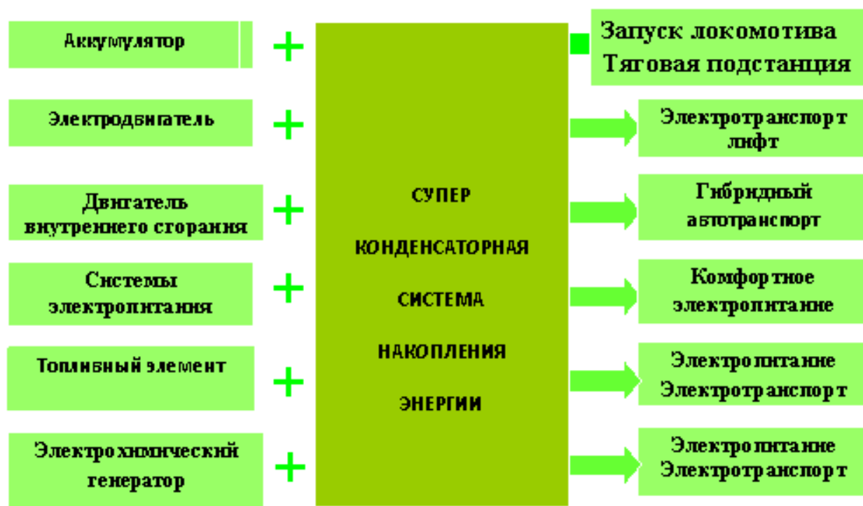
Рисунок 2.3– Комбинированные электроустановки с использованием суперконденсатора
