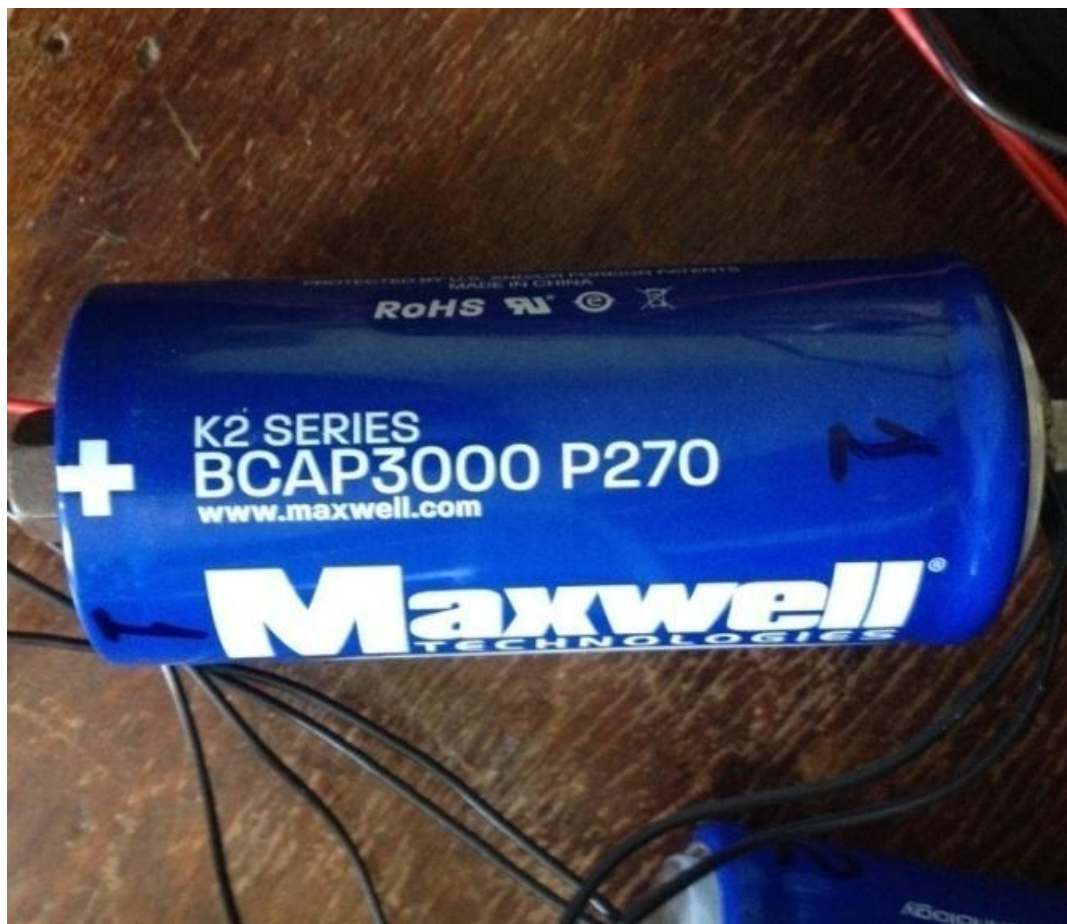
Рисунок 3.1– Суперконденсатор Maxwell Technologies BCAP270
