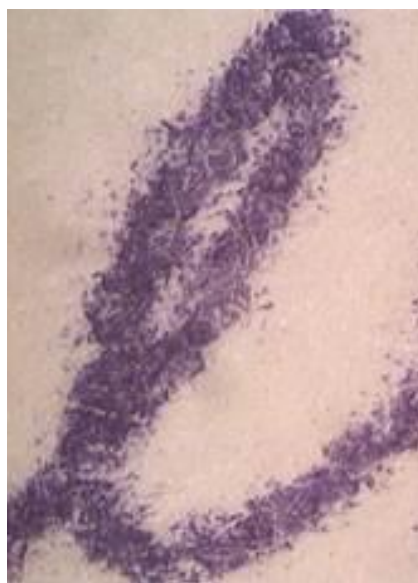
Иллюстрация 2.3.2 – микроструктура штриха, выполненного с помощью копировальной бумаги
