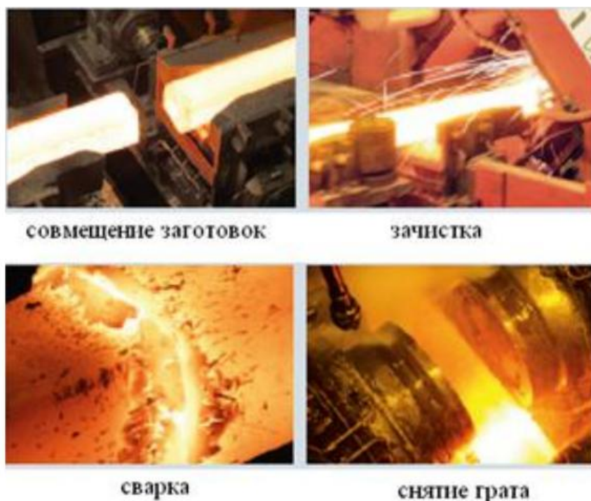
Рис. 4. Стадии процесса сварки заготовок
