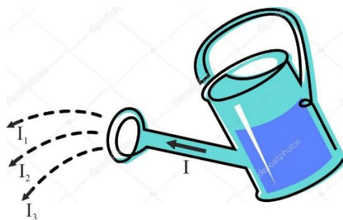
Рис. 1. Иллюстрация первого закона Кирхгофа
