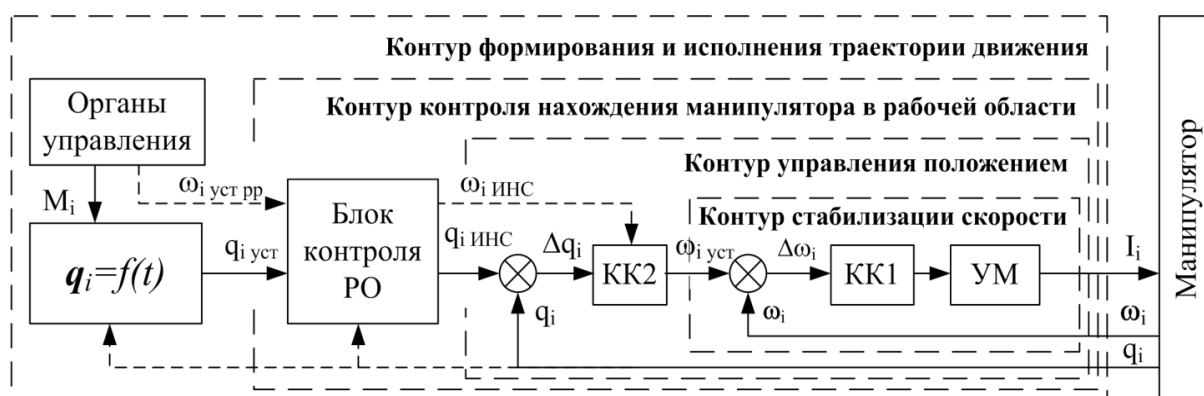
Рис. 3. Функциональная схема системы управления с контуром контроля рабочей области
