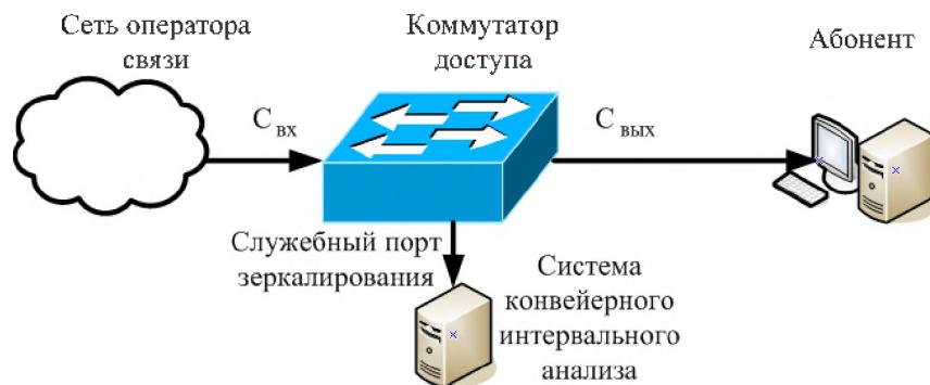
Рис. 1. Пример топологии включения системы анализа трафика
