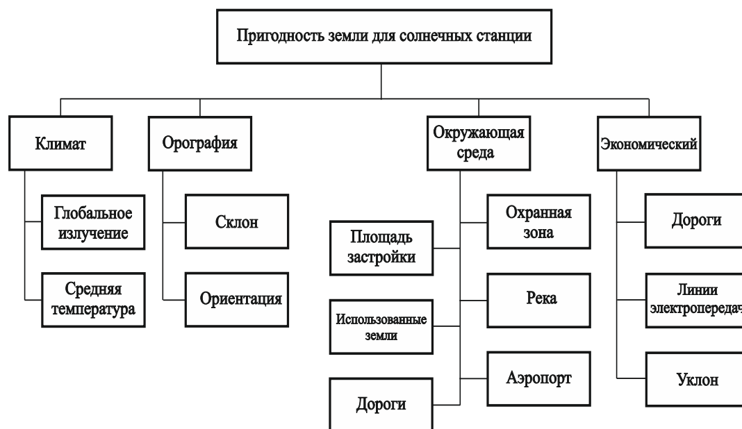
Рисунок 1 – Критерии и альтернативы принятия решения для выбора оптимальной площади строительства солнечной электростанции
