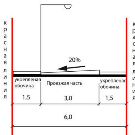
Рисунок 11 – Поперечный профиль проезда в жилой застройке
