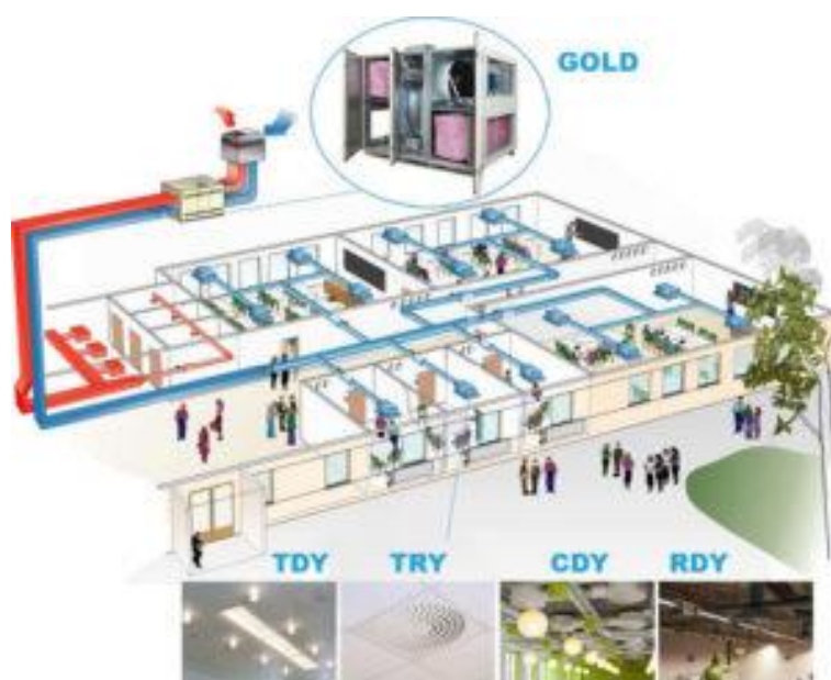
Рис. 14. Пример приточно-вытяжной системы вентиляции общественного здания
