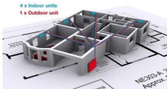
Рис. 15. Пример мульти-сплит системы
