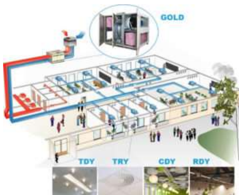
Рис. 34 Централизованные приточно-вытяжная система
