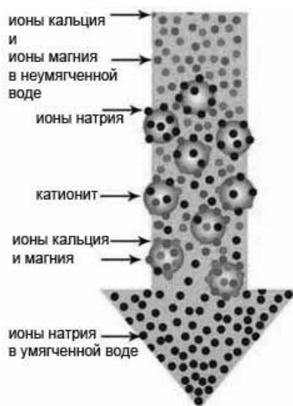
Рисунок 2.5.1 – Принцип ионного обмена
