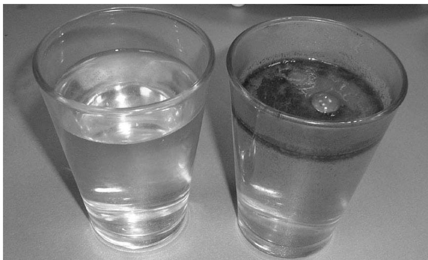
Рисунок 2.4.3 – Наглядное сравнение окисления двухвалентного железа
