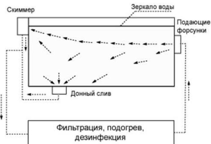
Рисунок 4 - Схема циркуляции воды в скиммерном бассейне
