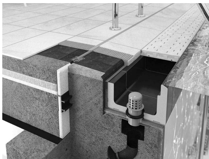
Рисунок 12 – Разрез устройства переливного желоба
