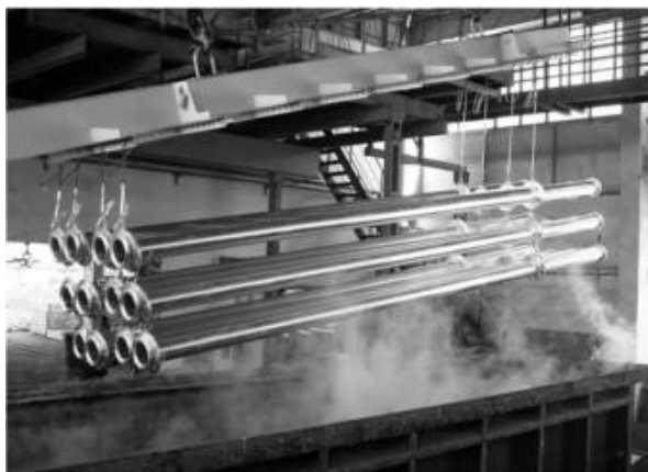
Рисунок 6 – Оцинковка стальных труб
