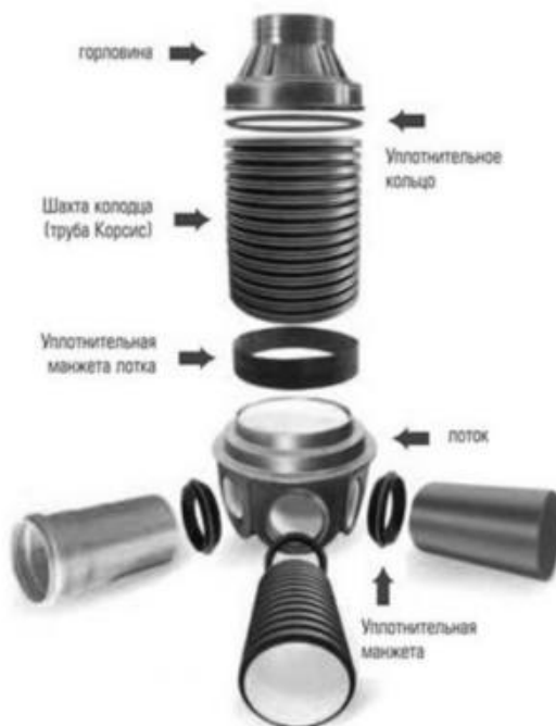
Рисунок 17 – Составляющие водопроводного колодца
